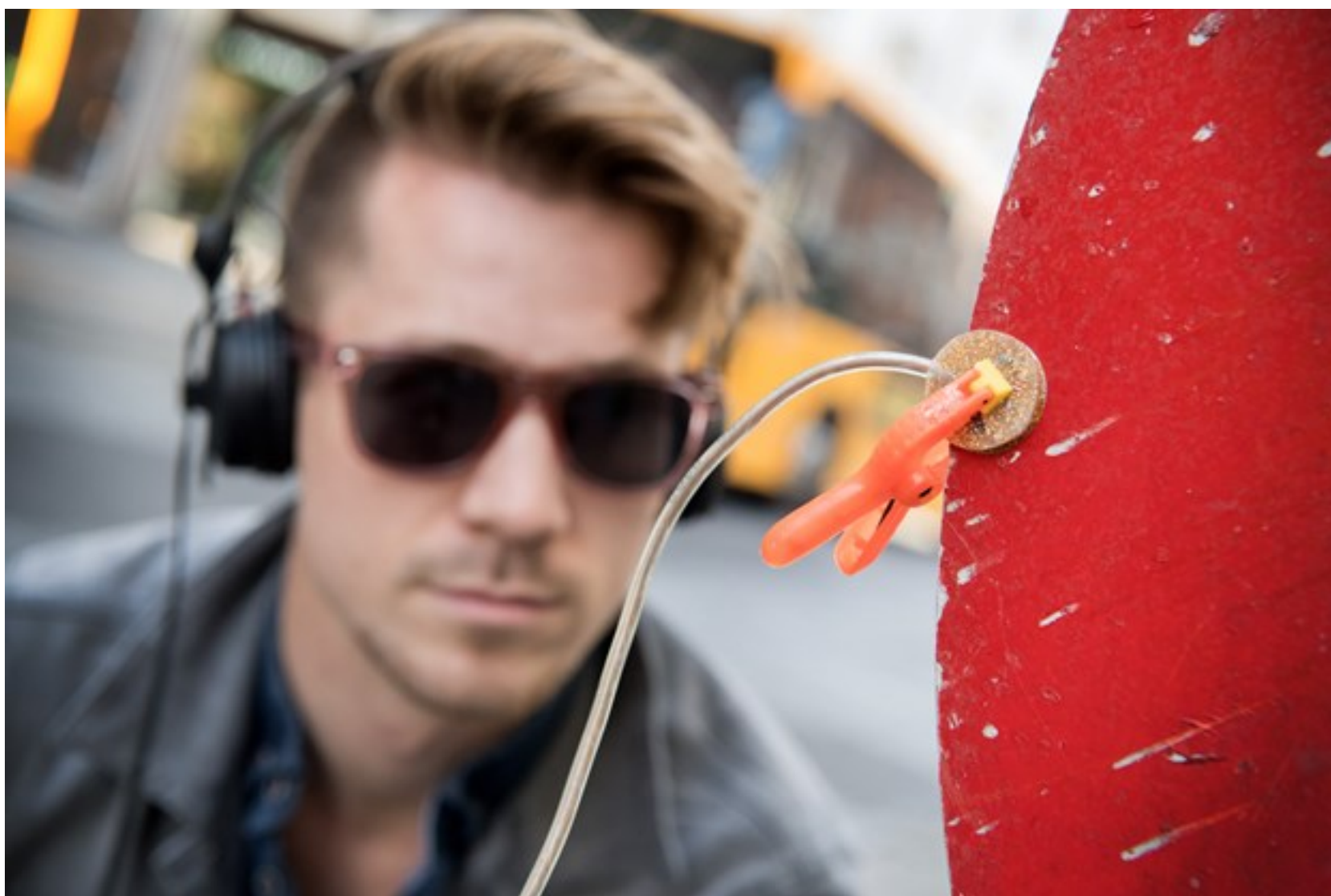
Lyd er ikke bare de svingninger, vi opfatter gennem øret. Med en lille mikrofon klemt fast på et vejskilt kan Morten Poulsen også opfange og fastholde de vibrationer, vi mere mærker end hører. Foto: Torben Hansen
